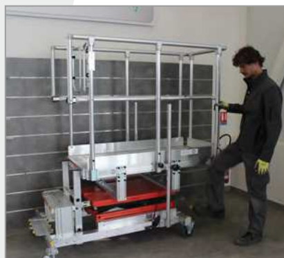
Elevación hidráulica de la plataforma por simple apoyo
